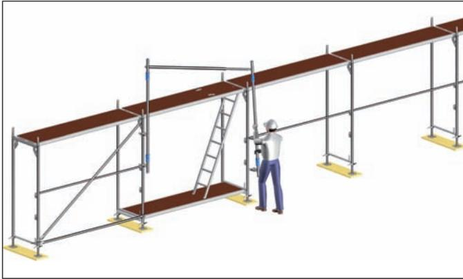
Bild 14: Montage des MSG im Aufstiegsfeld
