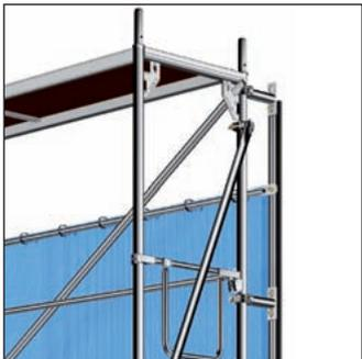
Bild 118: Aufbaubeispiel Kederplanensystem
