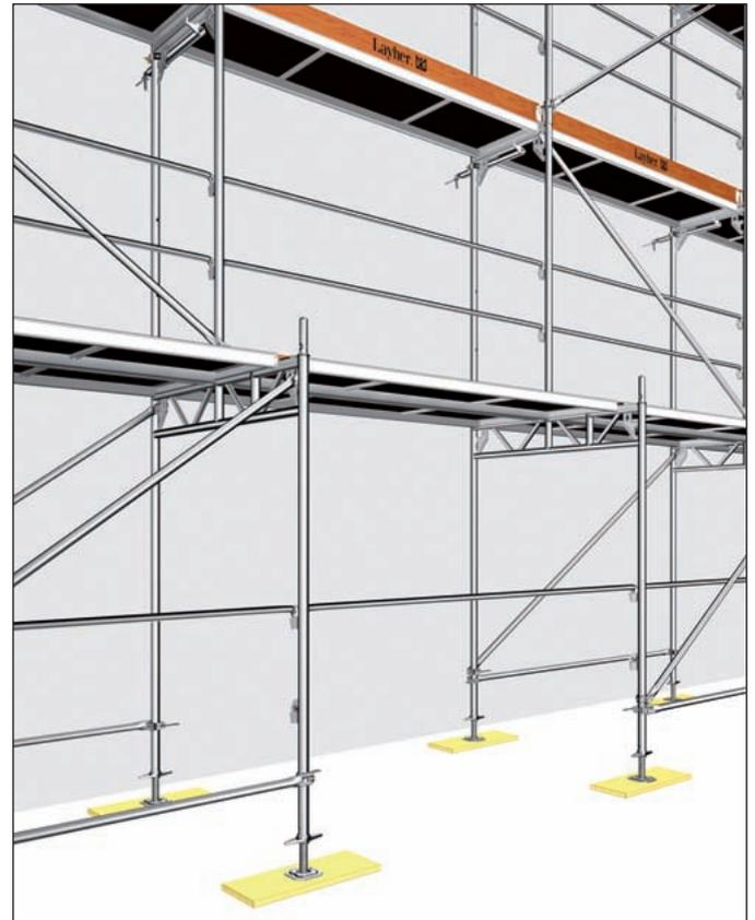
Bild 93: Einbau Durchgangsrahmen
