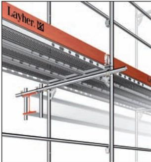
Bild 48: Verankerung an horizontalen Balken
