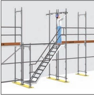
Bild 53: Verbindung zum Hauptgerüst
