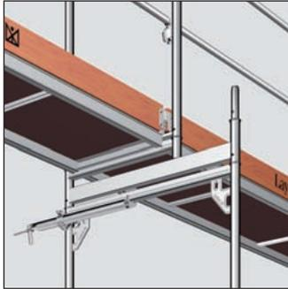
Bild 95: Verwendung Reduzierstück
