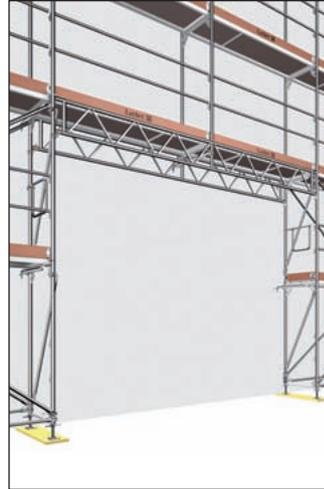
Bild 85: Gitterträgerüberbrückung
